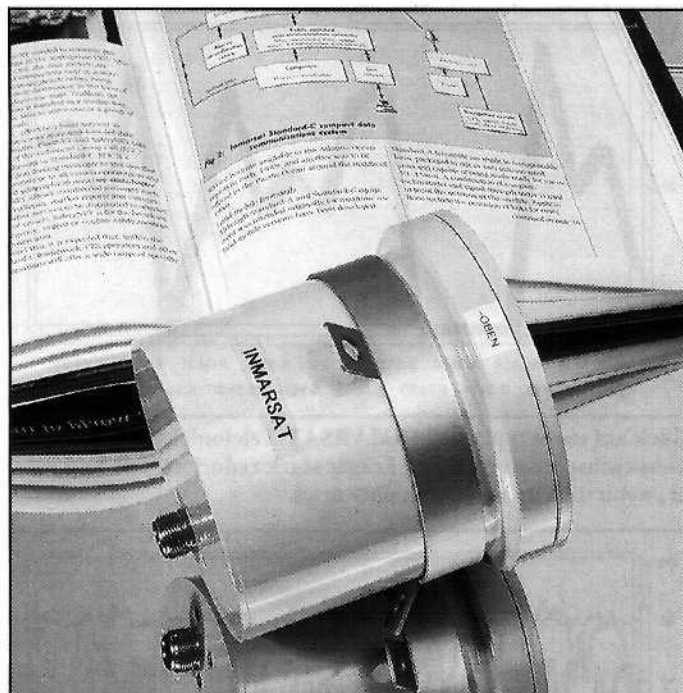
Wie immer: Das wahre Wissen steckt im Kopf. In diesem wetterfesten Kunststoffgehäuse ist die Aktivantenne untergebracht – hier eines von zwei Vorserienmodellen.
